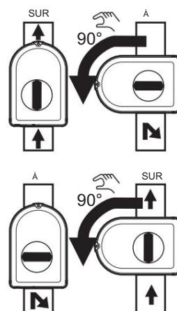
Fixation du moteur électrique au vanne à bille
