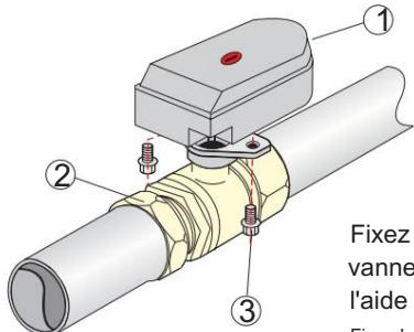
Fixez l'actionneur (1) à la vanne avec le support (2) à l'aide de deux vis (3)
