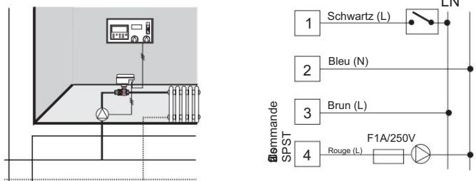
Lorsque le robinet à bille est complètement ouvert, le conducteur rouge est sous tension (phase), ce qui permet de démarrer la pompe de vidange. L'intensité admissible est de 1 A maximum. Pour des intensités supérieures, la commande doit être effectuée par un relais.
