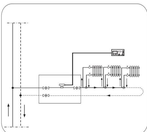
Régulation du chauffage du bâtiment par un thermostat d'ambiance et une vanne à bille motorisée.
